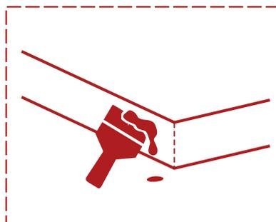
НАНОСИМ КЛЕЙ НА БОКОВОЙ КРАЙ УСТАНОВЛЕННОГО ПРОФИЛЯ, КОТОРЫЙ БУДЕТ СТЫКОВАТЬСЯ СО ВТОРОЙ ЗАГОТОВКОЙ
