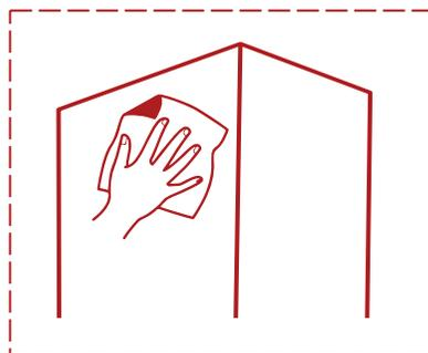
УСТАНОВЛИВАЕМ ПРОФИЛЬ В УГОЛ МЕЖДУ ПОТОЛКОМ И СТЕНОЙ, ЗАТЕМ ПЛОТНО ПРИЖИМАЕМ ДЕТАЛЬ НА 3-5 СЕКУНДЫ ТАКИМ ОБРАЗОМ, ЧТОБЫ ИЗЛИШКИ КЛЕЯ ВЫСТУПИЛИ.
