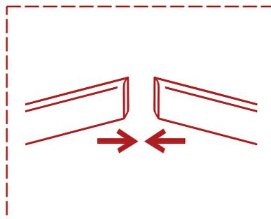
УДАЛЯЕМ ИЗЛИШКИ КЛЕЯ, ОСТАВШИЕСЯ МЕЖДУ ДВУМЯ ЗАГОТОВЛЕННЫМИ ПРОФИЛЯМИ
